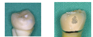
Bruch der Verblendung (Zirkondioxid) Bruch der Verblendung (lasergesintert) Alle Kronen zeigten Brüche an den Verblendungen, jedoch keine Defekte an den Stümpfen.
