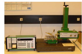
Messung der Abrasionsspur mittels Perthometer S6P (Mahr-Feinprüf, D)
