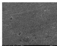
Abb. 8: REM-Aufnahme einer Gerüstkeramikoberfläche
